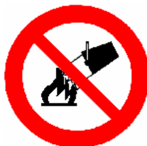
VIETATO SPEGNERE CON ACQUA
